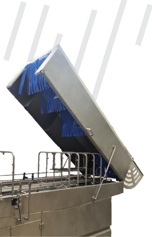
Bascule du couvercle pour mettre le tunnel en continu
