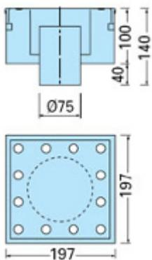
**DESCRIPTION :****Longueur :** 197 mm**Largeur :** 197 mm**Hauteur :** 140 mm**Diamètre Sortie :** 75 mm**Sortie :** Verticale ( par le fond )**Débit d'évacuation :** 50 L/min**Charge maximum :** 500 Kg**Poids :** 3.2 Kg*Les cotes d'encombrements sont susceptibles de varier*
