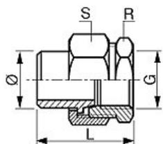
Raccord union à joint conique usiné dans la barre
